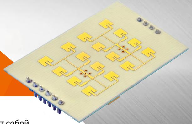
Модуль приемопередатчика MVS-162 ТСКЯ.464416.006 представляет собой компактный модуль, включающий в себя: антенную решетку (АР), реализованную в виде отдельных (передающей и приемной) частей; СВЧ-генератор, управляемый напряжением; встроенный малошумящий СВЧ-усилитель (МШУ); схему температурной компенсации СВЧ-генератора; квадратурный и синфазный выходы промежуточной частоты; два усилителя промежуточной частоты; низкочастотный выход пропорциональный частоте СВЧ-генератора.
